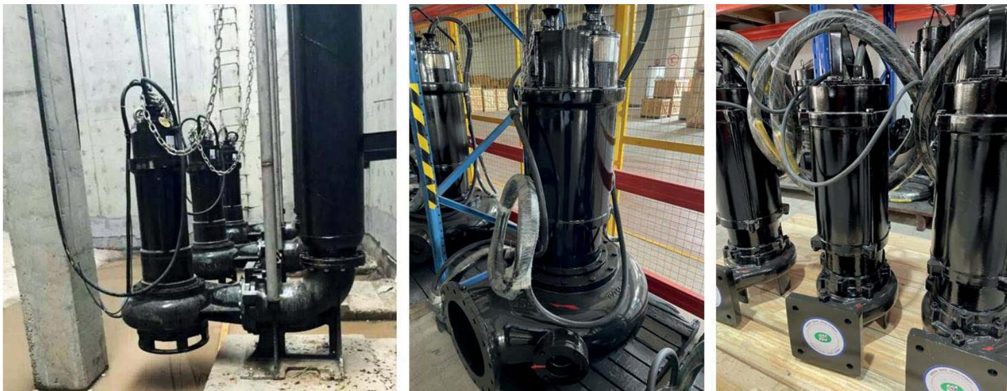
Погружные насосные агрегаты серии **SAF / SMF** предназначены для установки в колонну (вертикальный напорный трубопровод). Конструкция гидравлической части спроектирована для перекачивания больших объемов воды с относительно небольшими напорами.
